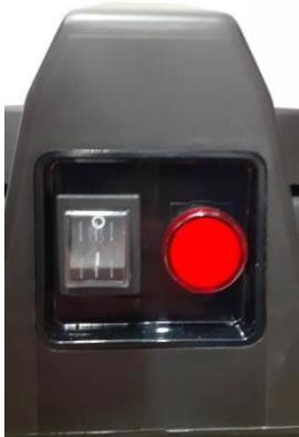
Der Motorkopf ist mit einem Schalter zum ein-/ausschalten sowie einer roten Lampe versehen. Bei zu niedrigem Luftdurchfluss (<20 m/s) leuchtet die Lampe als Warnung.
