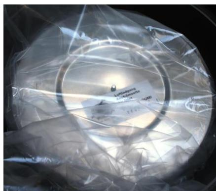
Træk en plastikpose (100 µm eller tilsvarende) ned over filteret.
