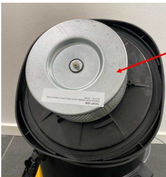
Afmonter motortoppen ved at løsne de to beholderclips, som holder motortoppen. Læg motortoppen således, at der er adgang til filteret.
