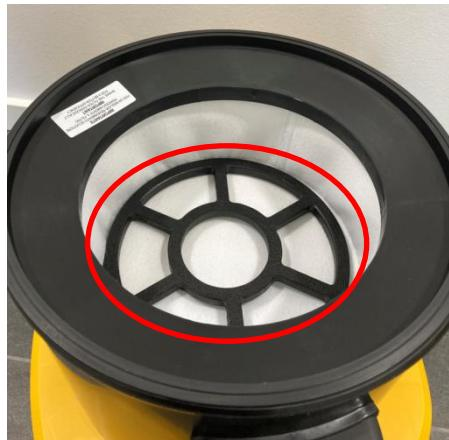
Der Distanzring sorgt dafür, dass der Vorfilter gestreckt bleibt und nicht um den HEPA-Filter gesaugt wird.
