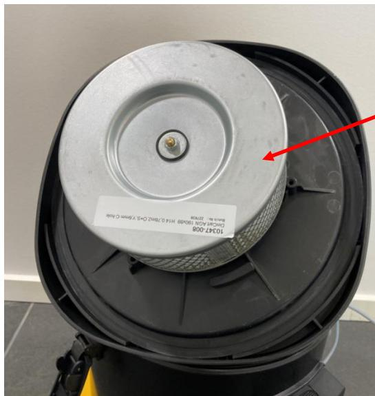
Die zwei Behälterklammern, die den Motorkopf festhalten, lösen, und den Motorkopf abheben. Den Motorkopf so anbringen, dass zum Filter Zutritt ist..
