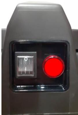
Motortoppen er forsynet med en rød lampe til alarmering ved for lav luftgennemstrømning (<20 m/s), samt en on/off kontakt til at tænde og slukke maskinen.
